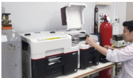
元素分析装置(有機化合物のC、H、Nの重量比を測定します)
