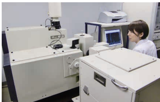
レーザーラマン分光光度計(分子の構造を解析します)
