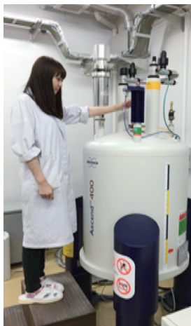
核磁気共鳴装置 (有機化合物の構造を解析します)
