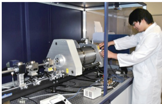
小角X線散乱測定装置 (ナノ材料の構造を解析します)
